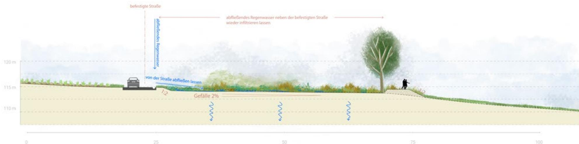
Querschnitt eines Straßenrandes, der genutzt wird, um abfließendes Regenwasser wieder zu infiltrieren.
